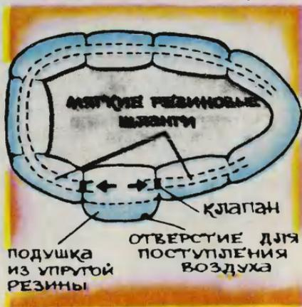
дится в действие ногой. Когда лодка накачана, входной клапан насоса закрывается, и можно отправляться в путь.
