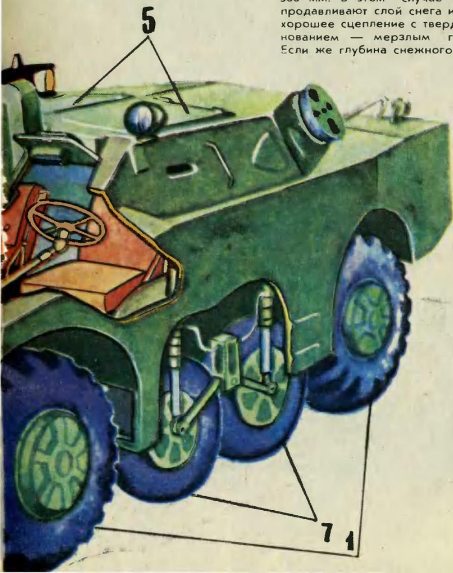
ва более 300 мм, то давление воздуха в шинах снижается.
